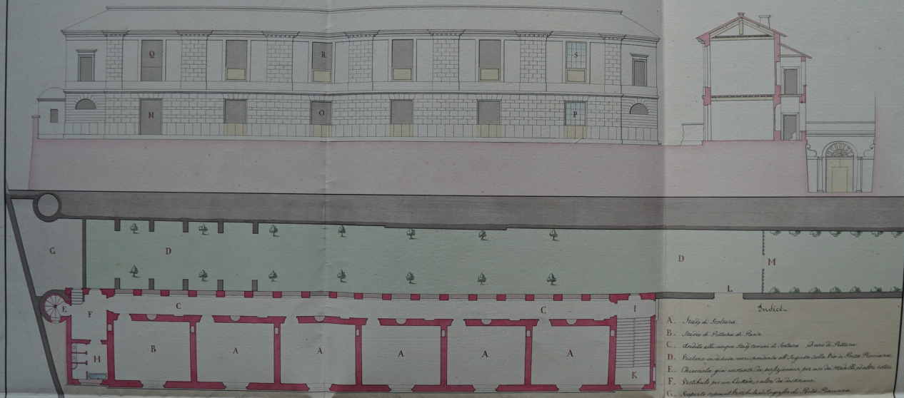
Pianta del Piano terreno de' Nuovi Staj di Scultura, al livello approssimativo del Cancello dell'Orto presso il grande Viale degli Orsini.
